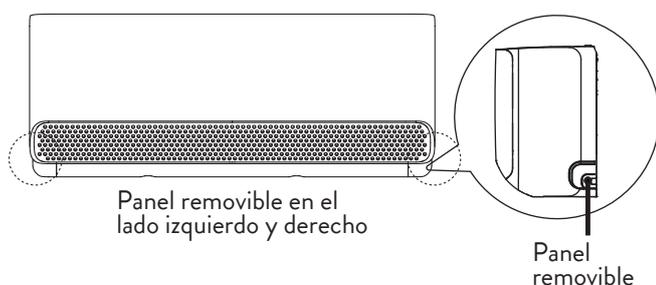
2. Si el orificio en la pared está detrás de la unidad, mantenga el panel removible en su lugar. Si el orificio está a un lado de la unidad, remueva el panel removible de ese lado de la unidad (ver fig. 3.3). Esto va a crear un orificio por donde puede salir la tubería de la unidad. Si no puede remover el panel a mano, puede utilizar una pinza pequeña para hacerlo.
