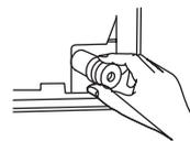
Para evitar fugas no deseadas, debe tapar el orificio de drenaje no utilizado con el tapón de goma provisto.
