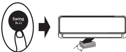
La rejilla horizontal oscilará hacia arriba y hacia abajo automáticamente al presionar el botón Swing.
