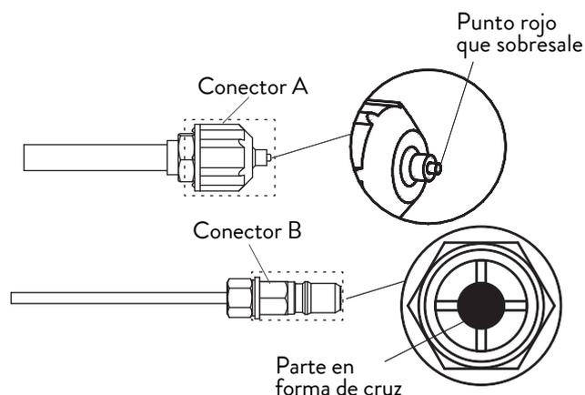
1. Antes de realizar la conexión de la tubería de refrigerante, use siempre guantes y gafas de trabajo y recuerde que los conectores A y B no pueden mirar directamente a las personas.
