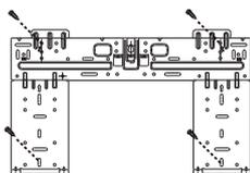
Orientación correcta de la placa de montaje
