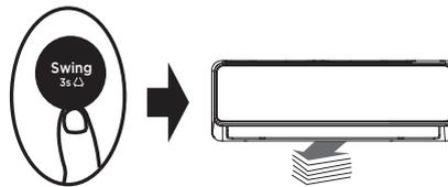
Si presiona repetidamente el botón SWING, se pueden configurar cinco direcciones diferentes del flujo de aire. La rejilla se moverá incrementalmente cada vez que presione el botón.
