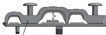
Cuando el cable no esté lo suficientemente apretado, use la hebilla para sostenerlo, de modo que se pueda sujetar firmemente.
