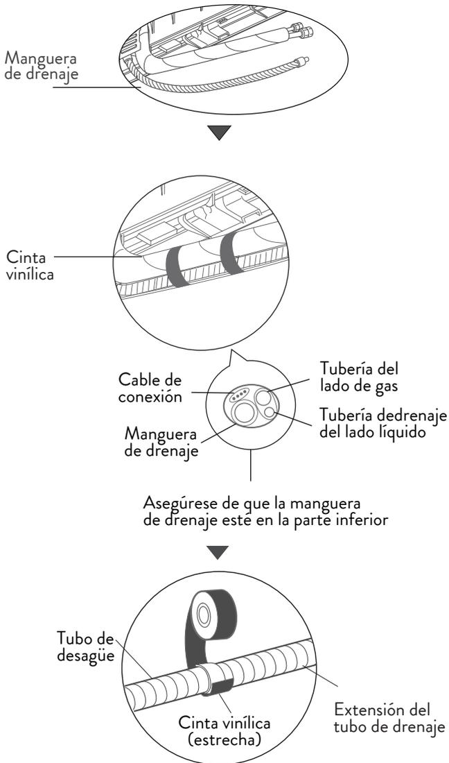
Por defecto, la manguera de drenaje está en el lado izquierdo del equipo (mirando desde la parte trasera). De todas maneras, también puede ser conectada al lado derecho.
