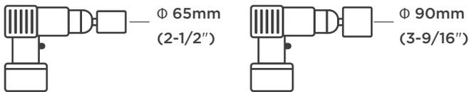
Usted debe realizar un orificio en la pared para la tubería de refrigerante, la tubería de drenaje y el cable de señal que va a conectar ambas unidades interior y exterior.
