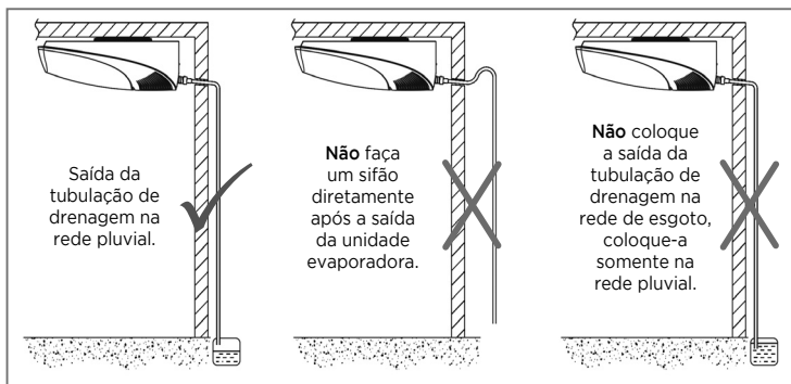
FIG. 17 - EXEMPLOS DE SITUAÇÕES DE DRENAGEM
