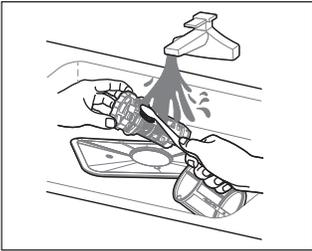
4. Setzen Sie die Filter in umgekehrter Reihenfolge wie bei der Demontage wieder zusammen, setzen Sie den Filtereinsatz wieder ein und drehen Sie ihn im Uhrzeigersinn bis zum Schließpfeil
