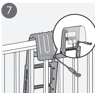
Suspendez le support au garde-corps et passez la corde en acier à travers le trou prévu à cet effet dans le support.
