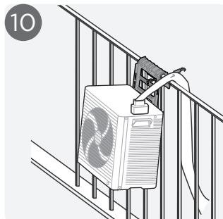
10 Deslice la unidad exterior suavemente hacia delante hasta que esté completamente insertada en el soporte y no pueda avanzar más. La instalación ha finalizado.
