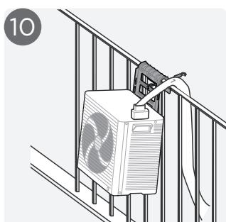
Faites glisser l'unité extérieure doucement vers l'avant jusqu'à ce qu'elle soit complètement insérée dans le support et ne puisse pas aller plus loin. L'unité extérieure est installée.
