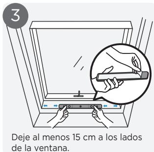
Con la ventana cerrada, fije la placa de montaje en la posición deseada del marco de la ventana.
