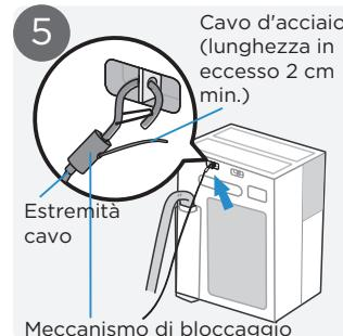
Collegare l'altra estremità del cavo d'acciaio ad uno degli occhielli sulla parte posteriore dell'unità interna.
