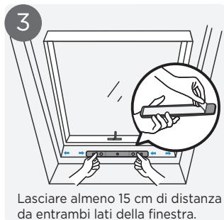
Con la finestra chiusa, fissare la piastra di montaggio nella posizione desiderata sul telaio della finestra.
