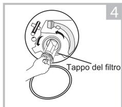
4 Aprire il filtro ruotando in senso antiorario
