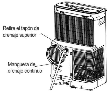
Durante el funcionamiento de la bomba de calefacción, retire el tapón de vaciado inferior de la parte posterior de la unidad, instale el conector de vaciado (5/8" hembra universal) con una manguera de 3/4" (adquirida localmente). Para los modelos sin conector de desagüe, basta con conectar la manguera de desagüe al orificio. Coloque el extremo abierto del adaptador de la manguera directamente sobre el área de drenaje del piso de su sótano.
