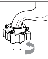
4. Ajuste la tuerca de la abrazadera
