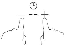
4. Когда время будет установлено, таймер сразу же начнет обратный отсчет. На дисплее отобразится оставшееся время, а сам дисплей таймера будет мигать в течение 5 секунд.
