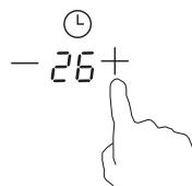
3. Если вы коснетесь одновременно кнопок "+" и "-", таймер будет сброшен, а на дисплее таймера отобразится"--".
