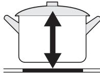
Зоны нагрева в определенной степени автоматически адаптируются к диаметру посуды. Однако для каждой зоны нагрева дно посуды должно иметь определенный минимальный диаметр. Если диаметр посуды меньше 140 мм, панель может не распознать ее.
