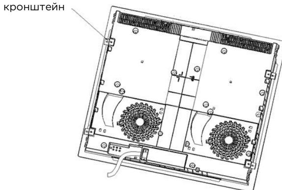
Отрегулируйте положение кронштейна до подходящего в зависимости от толщины стола.
