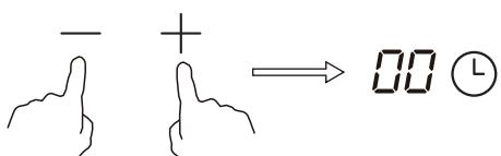
5. Когда время будет установлено, таймер сразу же начнет обратный отсчет. На дисплее отобразится оставшееся время, а сваm дисплей таймера будет мигать в течение 5 секунд.
