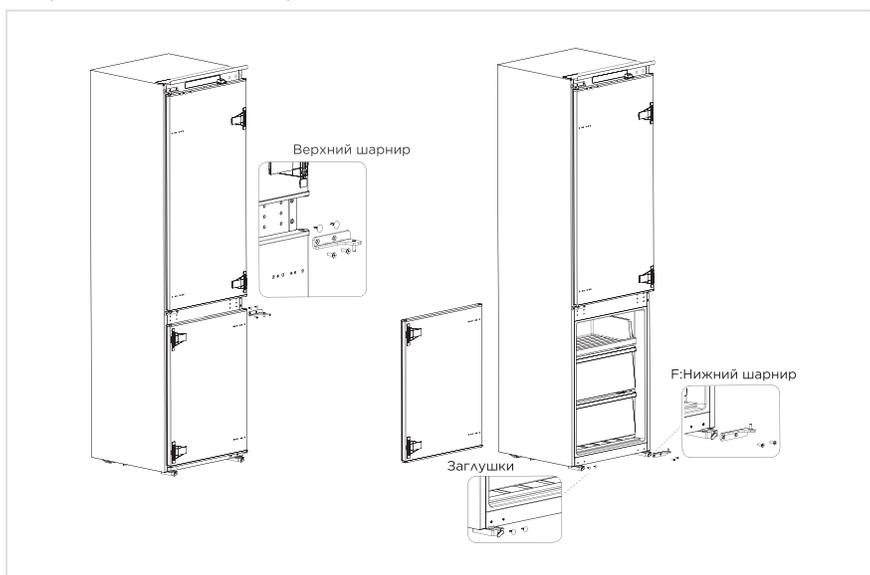
4. Поменяйте местами нижний шарнир и верхний шарнир двери морозильной камеры, установите их на новой стороне. Установите дверь на шарниры. установите заглушки на бывшее место верхнего шарнира.
