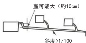
圖 4.5 集中排水接管方式
