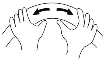
b. 彎曲薄壁連接管（如下圖）：
